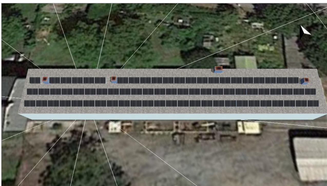
Obrázek: 1. Umístění modulu - Budovy 01-Plocha střechy Jihozápad
